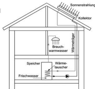
Schema einer solarthermischen Anlage
